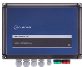
sterownik anteny RFID z funkcją autostrojenia
