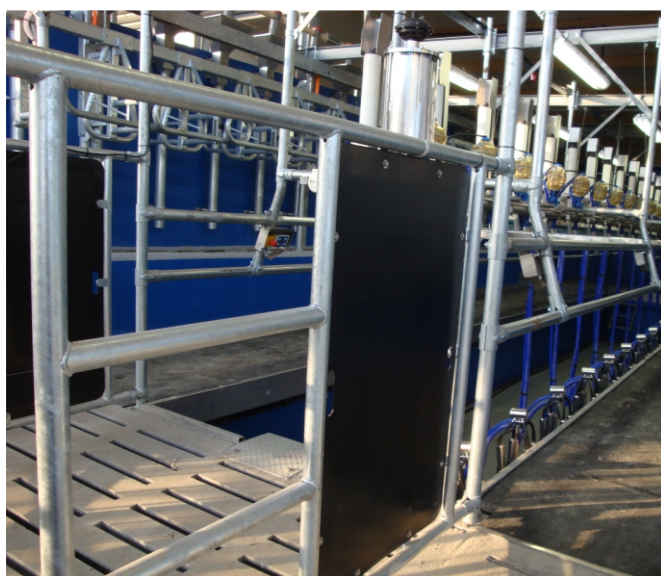
Typowa antena płaskożytna mocowana jest do konstrukcji na wejściu do hali udojowej
